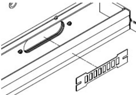
20. Bestimmen Sie die Position der einzelnen Rinnen so, dass sie mit der Anordnung der Abflusslöcher in den Streben übereinstimmt. Beginnen Sie mit der Montage der Rinnen an beiden Seitenstreben (mit den Lamellenlöchern).
