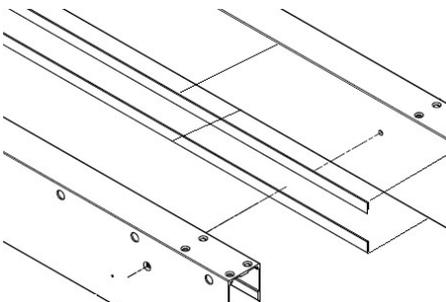
11. Bei Modulen: Nachdem Sie die Oberfläche entfettet haben, kleben Sie zwei Streifen EPDM-Band auf die Strebe des Pergolarahmens, den Sie hinzufügen (im Zubehör beigelegt). - Zeichn. 18.
