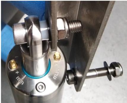
8. Beim Elero-Motor ist zwischen dem Zugstangenhalter und dem Motorkolben eine zusätzliche Distanzhülse aus Kunststoff angebracht (Zeichn. 32).
