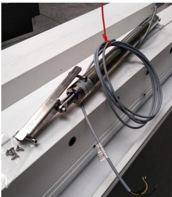
4. Der Motor ist werkseitig mit dem Motor- und Zugstangenhalter montiert. Konische Schrauben, die den Motorhalter an der Strebe befestigen, sind in einem separaten Beutel verpackt (Zeichn. 30).
