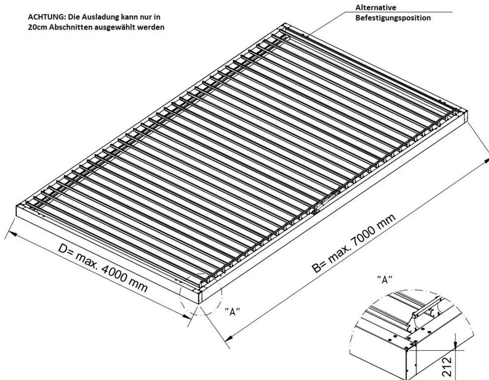
Zeichn. 1. Pergola SB 400 R - Abmessungen: **D max** – max. Breite, **B max** – max. Ausladung, **H** – Höhe (212 mm)
