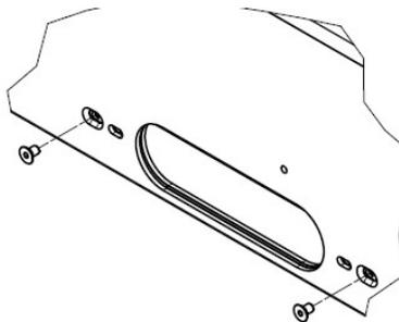
6. Mit 2 M5x8 Schrauben (in den äußeren Löchern) festziehen (Zeichn.13).
