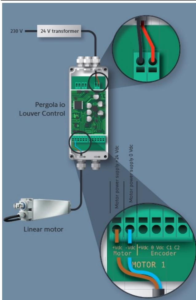
Zeichn. 39 Anschlussdiagramm im Funkempfänger Pergola io Louver
