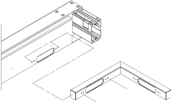
4. In jede Ecke der Querstreben sind Ecküberläufe einzusetzen (in die untere Kammer durch die seitliche Öffnung unterhalb des Verbindungsstücks (Zeichn. 12-oben).
