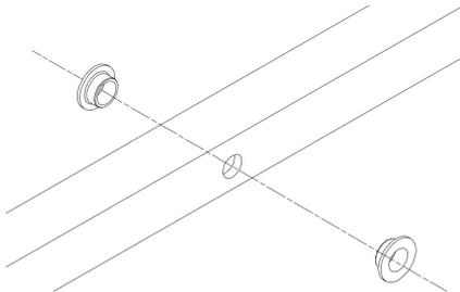
1. Stecken Sie die kleinen Plastikhülsen auf beiden Seiten der Zugstange (quadratisches Profil 20x20) in die Öffnungen (Zeichn. 33).
