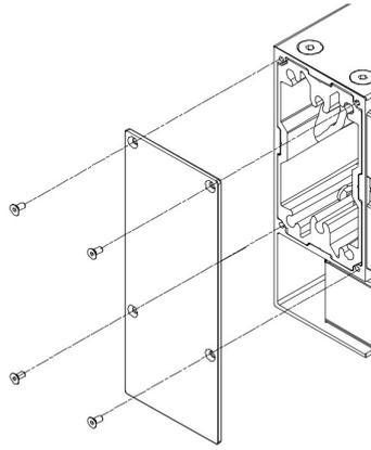
8. An beiden Enden der Querstrebe die Abdeckkappe 85x212 ansetzen und mit 4 Schrauben M4x8 festziehen (Zeichn. 15).
