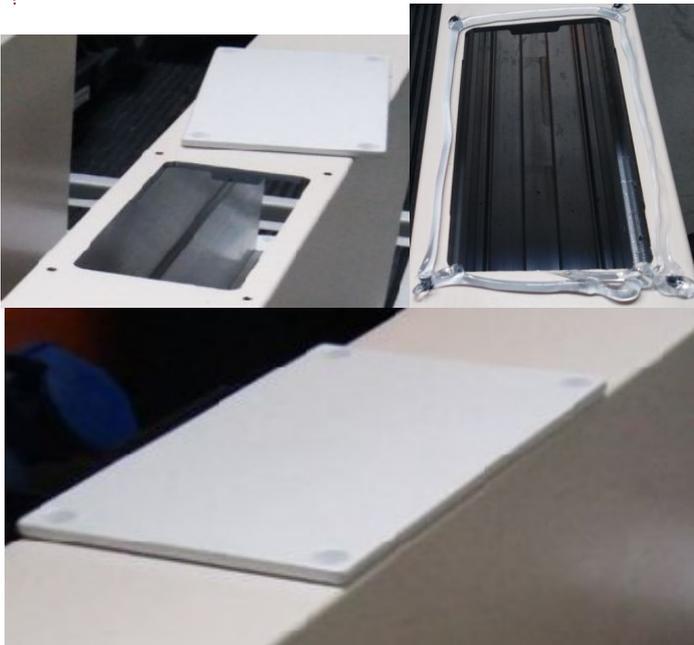
17. Optional ist es möglich, eine zusätzliche Revisionsklappe auf der Strebenoberseite auszuführen. Sie dient zur Einführung von Steuerungs- und Automatisierungselementen.
