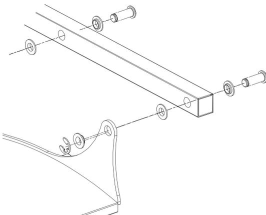
2. Legen Sie die Zugstange an der Außenseite der Lamellenendkappen an. Fangen Sie mit einer beliebigen Lamelle an und stellen Sie so, dass die Löcher in der Endkappe mit denen in der Zugstange übereinstimmen. Schieben Sie nun die Splints soweit in die Löcher (von welcher Seite spielt keine Rolle) bis auf der anderen Seite die Rille auf dem Splint zu sehen ist. Setzen Sie nun den kleinen Sicherungsclip ein (Zeichn. 34).
