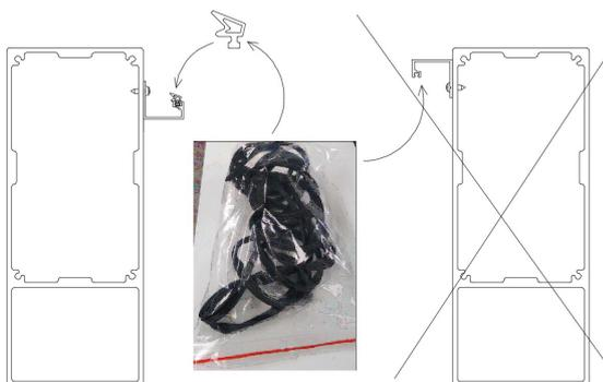
3. Zum Zubehör gehört 1 Stück aufgerollte Lamellengummidichtung in einem Plastikbeutel. Vor der Montage des Rahmens ist diese in die Nut (die wie ein „U“ nach oben zeigt) der ergänzenden Lamelle der Querstrebe einzuschieben (Zeichn.11). Für die zweite Querstrebe wird keine Dichtung verwendet.
