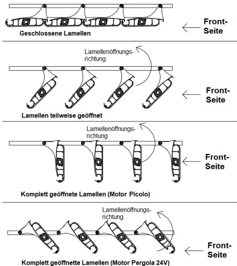
Zeichn. 3. Standardöffnungsrichtung der Lamellen der Pergola SB 400 R.
