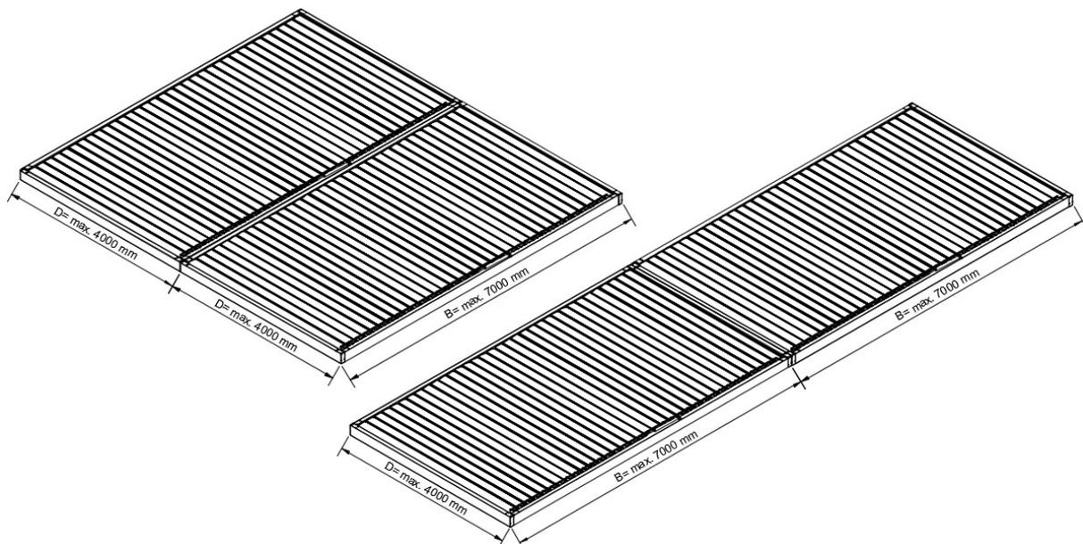
Zeichn. 2. Pergola SB 400 R Längs- oder Querverbindung – durch die Quer- oder Seitenstreben
