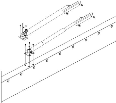
5. Je nach Motormodell müssen Sie den Motor mit Motorhalter (Aussehen hängt vom Motormodell ab) an der Strebe mittels der ST6,3x16-C-H-Flachkopfschrauben (im Zubehör mitgeliefert) in den vorhandenen Löchern auf der Antriebsseite (Strebenoberseite) festschrauben. Der Kabelausgang befindet sich auf der Motoroberseite. Der Zugstangenhalter sollte mit den 2 Löchern so zur Strebenseite mit den Löchern für die Lamellen zeigen (Zeichn. 31).
