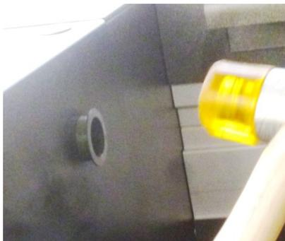
9. Setzen Sie die fehlenden Kunststoffhülsen in die äußersten Löcher in den seitlichen Streben ein (Zeichn. 16).
